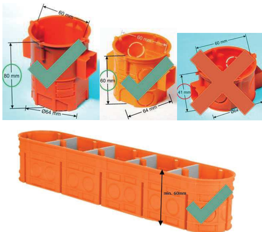
Rysunek 20. Zalecane wymiary puszek elektroinstalacyjnych. Źródło: www.simet.com.pl
