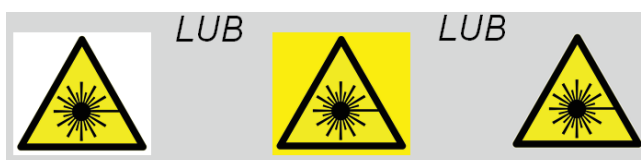
Rysunek 15. Wzór naklejki ostrzegawczej. Źródło: Norma PN-EN 60825-1
